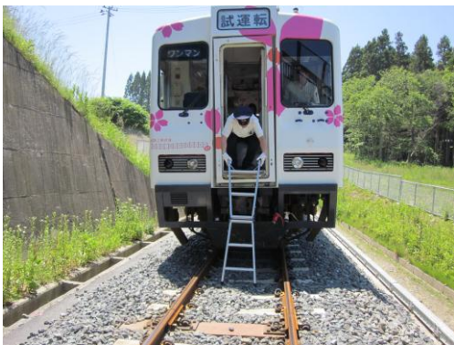
避難ハシゴ設置
