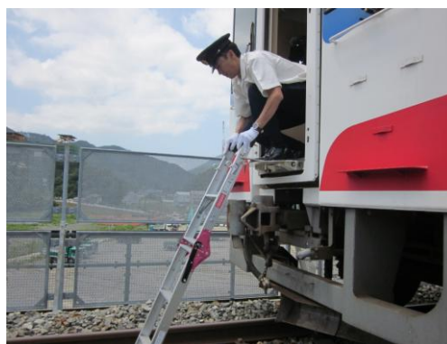
地震発生、避難はしご設置
